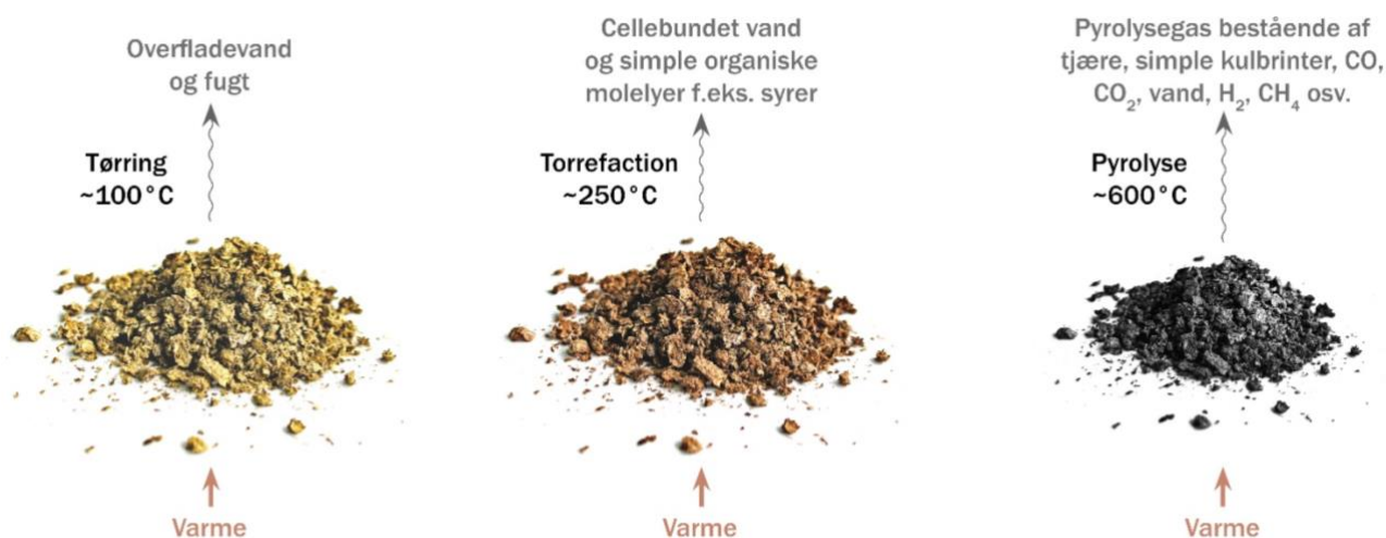
Figur 1: Illustration af de processer som organisk materiale gennemgår ved opvarmning uden tilførsel af ilt. Typiske procestemperaturer angivet.
